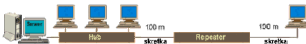
Rys. 3.6 Sieć oparta na skrętce z odległą stacją – topologia: gwiazda
